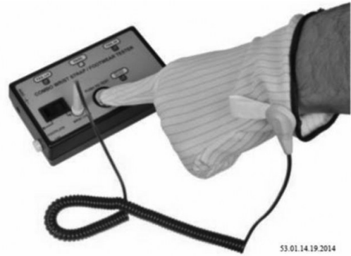
图19 戴着手套使用综合测试仪的手腕带测试
