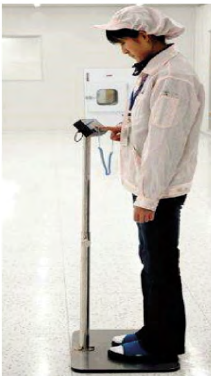
▲ 测试佩戴腕带时系统电阻
