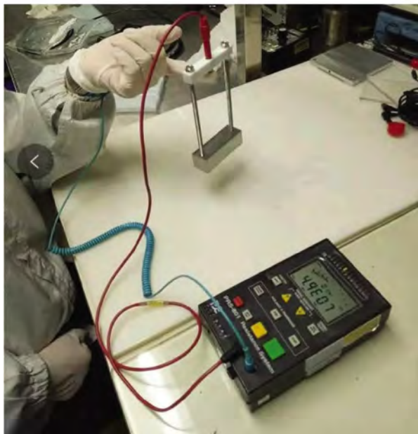
手套对地电阻的测试
