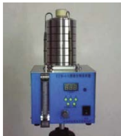
图10 撞击式空气微生物采样器
