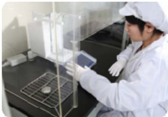
图 4 NVR 测试示意
